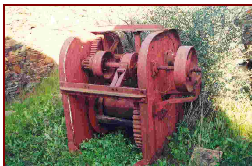
Figura 4 – Sarilho, máquina usada para puxar as vagonetas de minério e estéril
